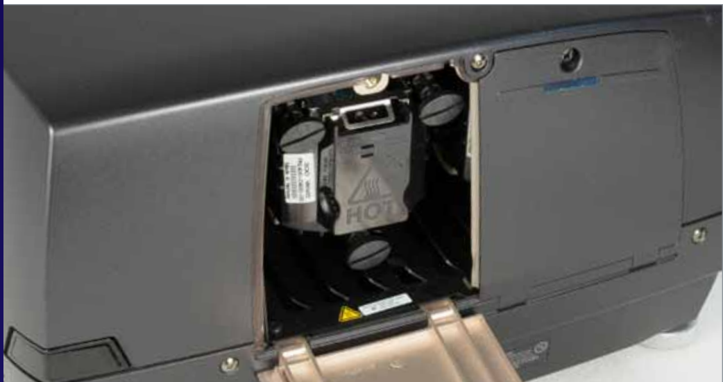
▲ Die DuArch™ Dual Illumination Architecture umfasst Lampenkammern, die vom Benutzer während des Betriebs ausgetauscht werden können.
